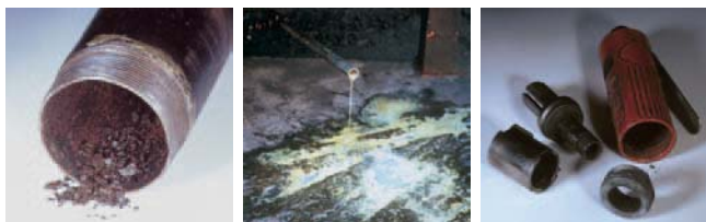
Korrosion Unerwünschter, aggressiver Schlamm Beschädigte Werkzeuge
