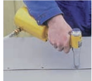
Schnelles und zuverlässiges Nieten von Blechen
